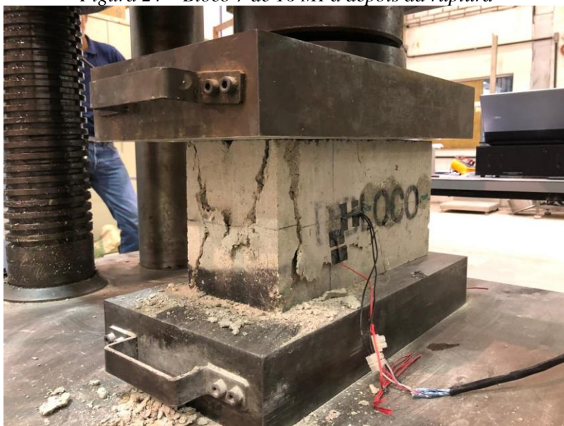
Figura 25 – Bloco 8 de 6 MPa depois da ruptura
