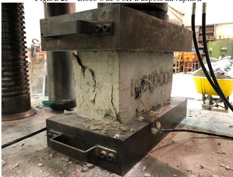
Figura 25 – Bloco 8 de 6 MPa depois da ruptura
