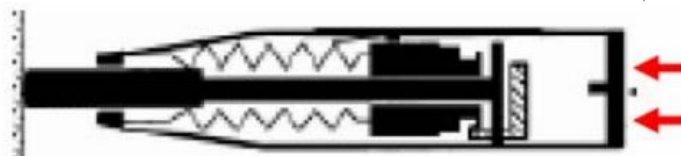
Figura 4 - Sistema massa-mola do esclerômetro antes da colisão (Thomaz, 2007)
