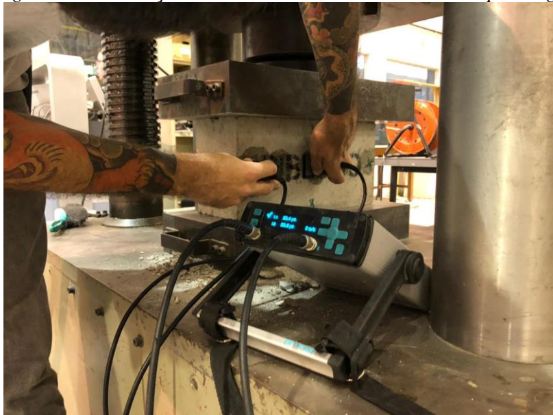
Figura 20 – Realização de ensaio de ultrassom indireto com pré carga
