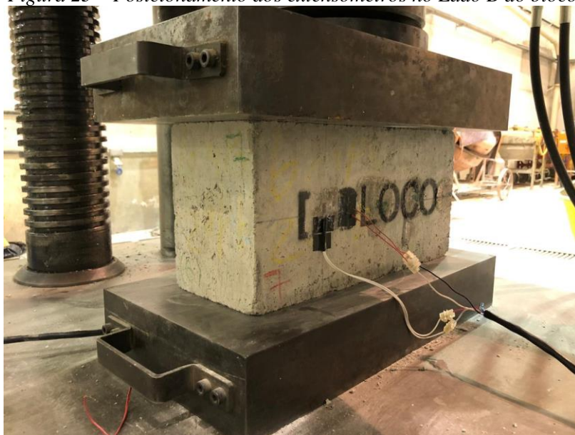
Figura 23 – Posicionamento dos extensômetros no Lado B do bloco
