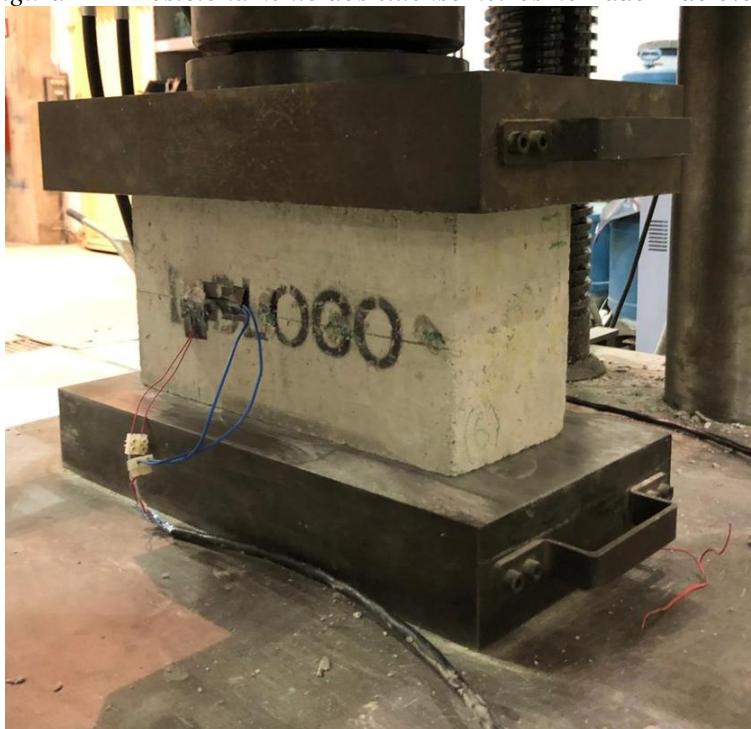
Figura 22 – Posicionamento dos extensômetros no Lado A do bloco
