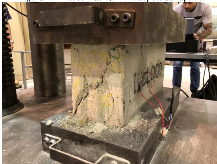
Figura 26 – Bloco 8 de 4,5 MPa depois da ruptura
