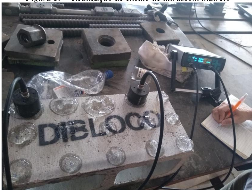
Figura 19 – Realização de ensaio de ultrassom indireto
